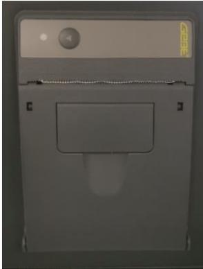
Das Teledata USB V12 ist zusätzlich mit einem integrierten Thermodrucker ausgestattet. Hiermit können Wägedaten und zahlreiche Sonderinformationen auf Thermopapier gedruckt werden
