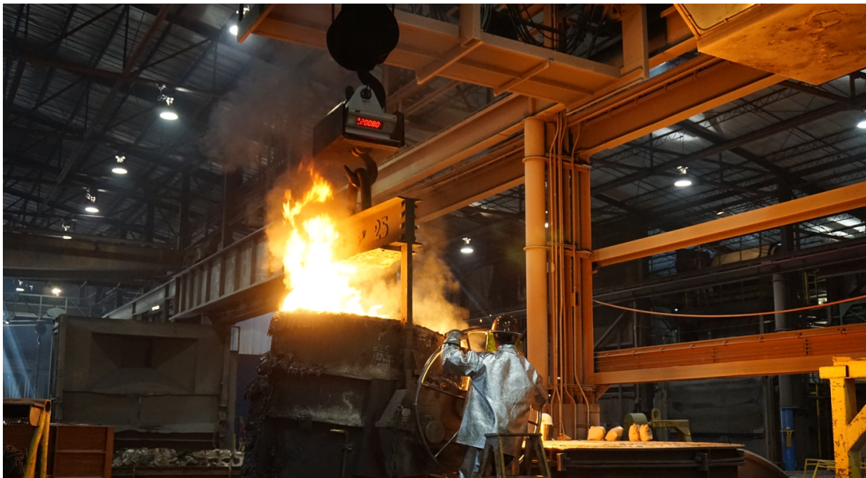
Kranwaage im Gießereieinsatz
